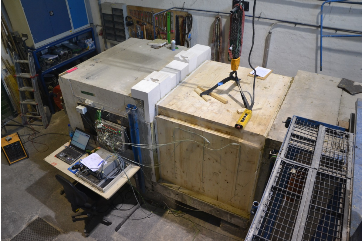
Abbildung 3-3 Gesamtansicht des Brandversuchstandes mit eingebautem Prüfkörper. Der Brenner befindet sich am linken Bildrand, der Schornsteinanschluss rechts, der Prüfkörper wird längs von links nach rechts von Heizgasen durchströmt. Links unten im Bild ist die Messtechnik zur Aufzeichnung der Temperaturmesswerte zu erkennen.
