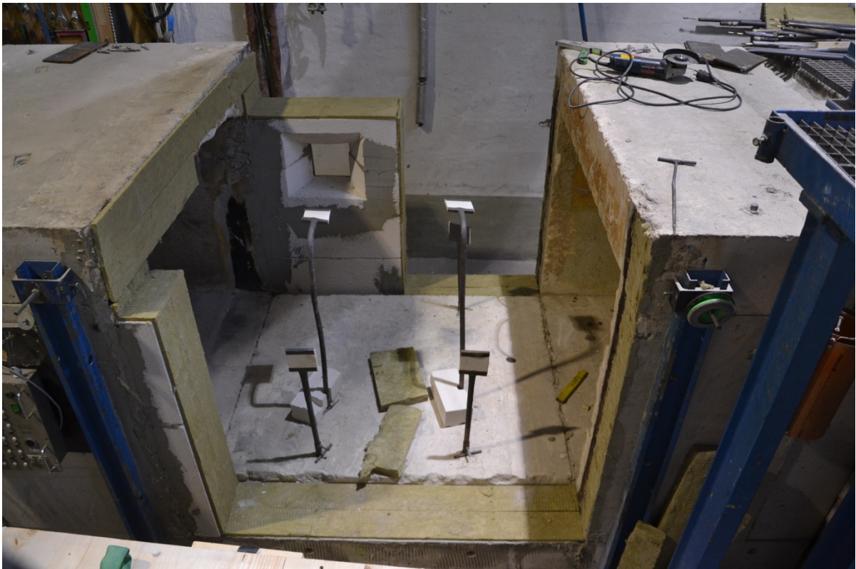
Abbildung 3-5 Ansicht des Prüfstandes ohne Prüfkörper, mit eingebauten Thermoelementen zur Messung der Ofentemperatur.
