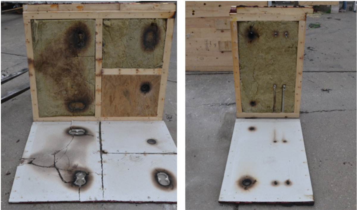
Abbildung 3-15 Versuch V2a nach dem Abnehmen der Bekleidungs- und PVC-Schichten, es sind keine Verkohlungen am Holz sichtbar
