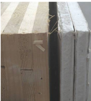
Bild A.4: Massivholzschale des Prüfkörpers IWT 2 bzw. TW 2, Seitenansicht, Montagezustand nach dem Anbringen der Gipskartonbeplankung auf einer Seite
