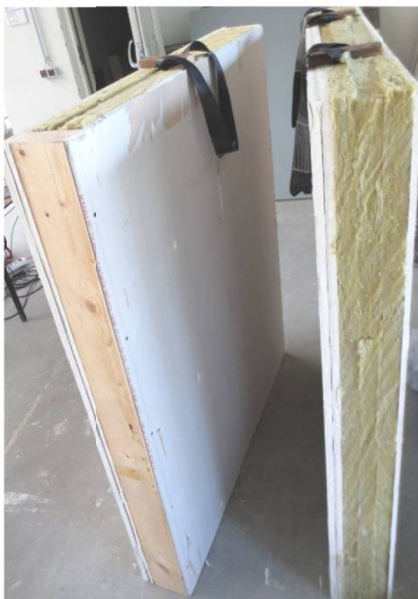
Bild A.7: Prüfkörperschalen TW 4 beim Transport zum Prüfstand
