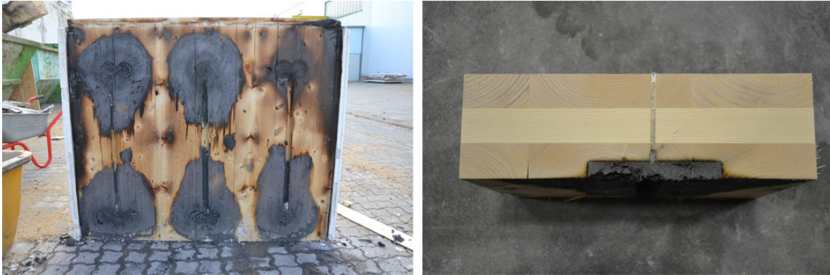
Abbildung 3-32 rechts das Wandelement aus Brettsperrholz nach Abbau der Bekleidung, die schwarzen Verfärbungen stammen von Resten des aufgeschäumten Brandschutzanstriches. Links ein horizontaler Schnitt durch den Prüfkörper im Bereich einer Dosenaussparung. Es sind keine Verkohlungen aufgetreten, der Anstrich konnte die Dosenlöcher selbst sowie die Kabelschlitze gut abdichten.
