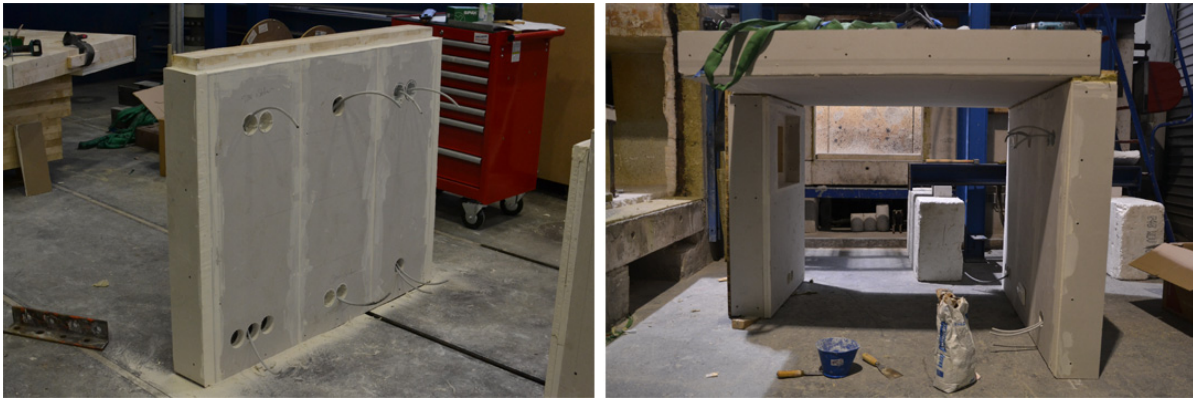
Abbildung 3-28 V4: Wandelement aus Brettsperrholz mit Bekleidung, zusammengebauter Prüfkörper vor dem Einbau in den Prüfofen
