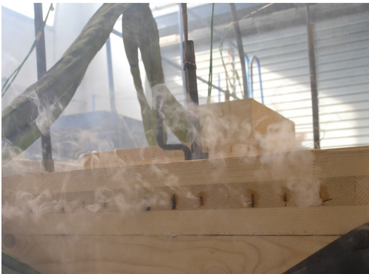
Abbildung 2-5 dreilagiges unbelacktes Brettsperrholzelement im Brandversuch, deutlich zu erkennen ist der Rauchgasdurchtritt zwischen den inneren Lamellen
