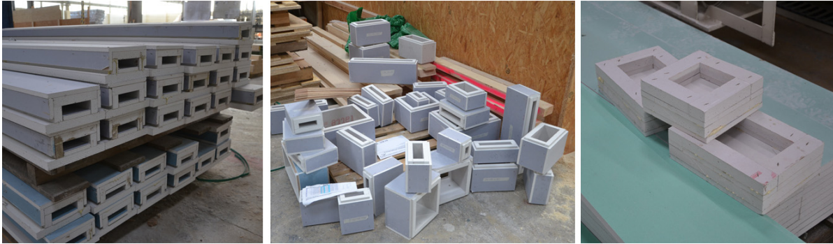
Abbildung 2-11 Praxisbeispiele für zusätzliche Gipsplattenkästen zum Einbau von Elektroinstallationen
