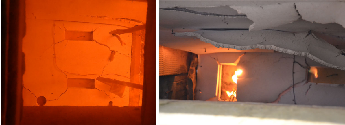
Abbildung 3-9 V1: links Blick in den Prüfofen nach ca. 30 Minuten Versuchszeit mit deutlich sichtbaren Schrumpfungsrissen in der Bekleidung ausgehend von den Ecken der Aussparungen, rechts der Prüfkörper unmittelbar nach Ende der Versuchszeit, es sind Flammen von brennenden Holzbauteilen erkennbar.
