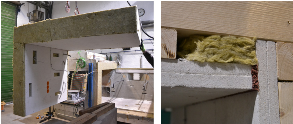
Abbildung 3-8 Versuchskörper Brandversuch V1 Gesamtansicht und Fugendetail
