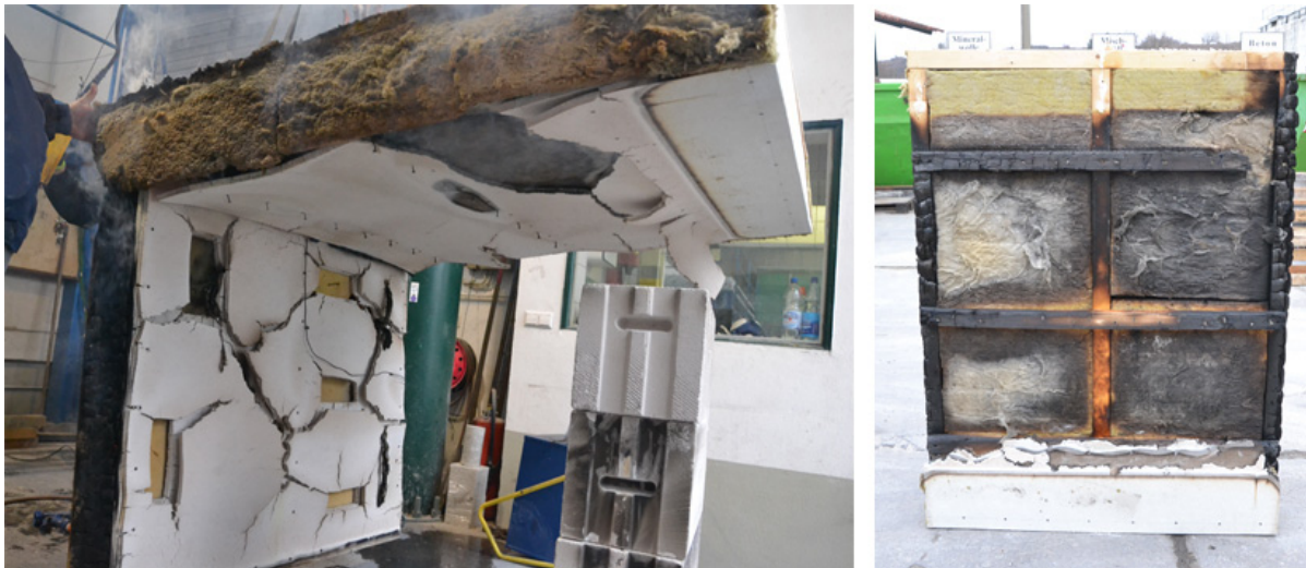
Abbildung 3-10 Versuchskörper V1 nach dem Herausheben aus dem Prüfofen. Die Bekleidung zeigte grobe Risse und ist teilweise abgefallen. Die Holzteile waren erheblich verkohlt, das Kapselkriterium wurde nicht eingehalten.
