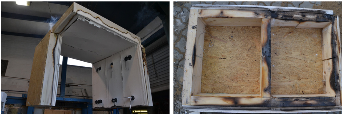
Abbildung 3-31 V4 unmittelbar nach der Prüfung (links), rechts das kleine Wandelement nach Abbau der Bekleidung, es sind Verkohlungen im Bereich der Eckfugen sichtbar.
