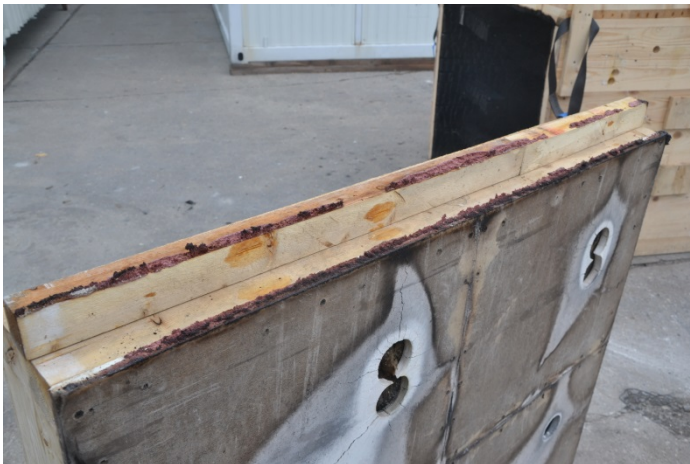
Abbildung 3-16 Versuch V2a: Ansicht des Fugenbereichs nach der Versuchsdurchführung. Es sind nirgends verfärbte/verkohlte Stellen aufgetreten, der Brandschutzschaum hat die Fuge vollständig ausgefüllt.
